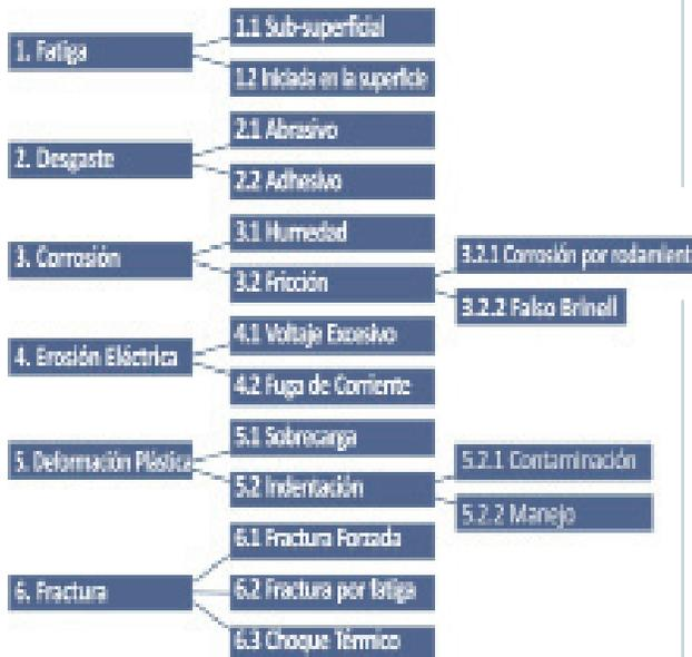
Imagen N°2: Modos de Falla de un Cojinete
